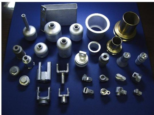
押出棒・型材切断品
